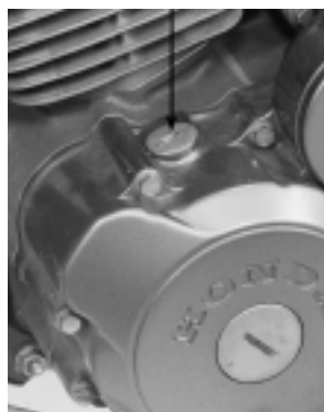
TAMPA DO ORIFÍCIO DA ÁRVORE DE MANIVELAS
