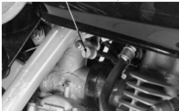
PARAFUSO DE ACELERAÇÃO
